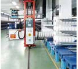
**自动络筒打包立体仓库:** 涤纶长丝生产过程中,自落丝、丝饼运输、包装至仓储管理的全流程作业，用“机器换人”，实现工业化、信息化、智能化的“三化融合”。
