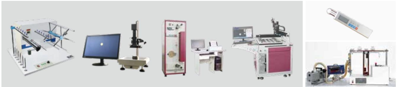
检测仪器：单纱强力机、缕纱测长机、喷丝板镜检仪、水分测定仪、张力仪等各种检测设备。
