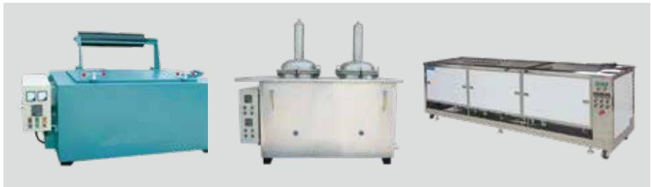
预热煅烧、清洗设备：纺丝过滤等部件的预热、煅烧、超声清洗等。
